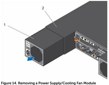
1. Power supply/cooling fan module
